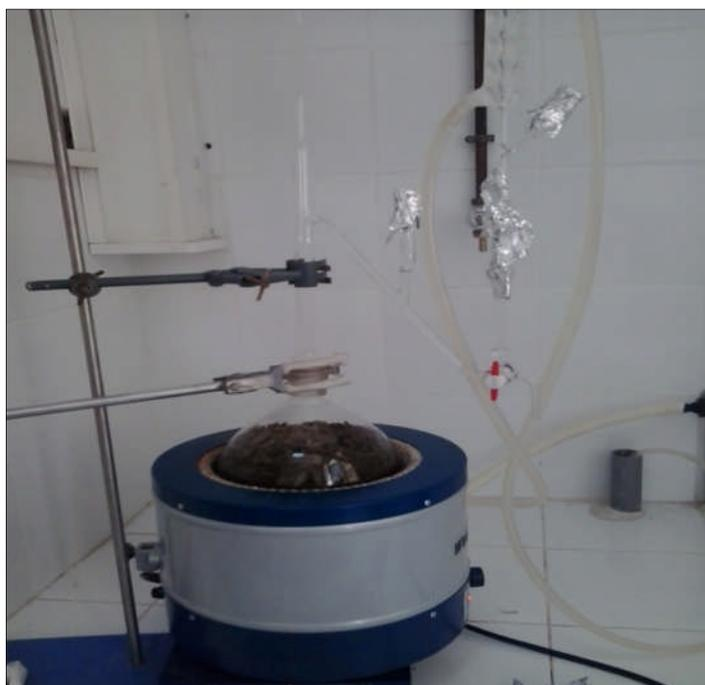
**Figure 21.** Montage d'hydrodistillation.
