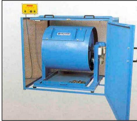
**Figure III.4. Appareil pour essai Los Angeles**
