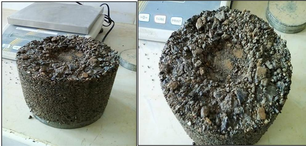
**Figure IV.7. Eprouvettes après poinçonnement**
