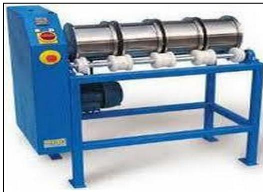
**Figure III.5. Appareil pour essai Micro Deval.**
