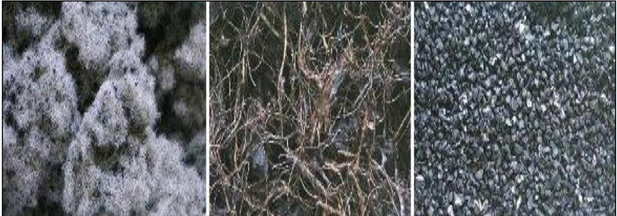
**Figure II.19. Les principaux constituants des différents produits obtenus par broyage de pneus usés.**
