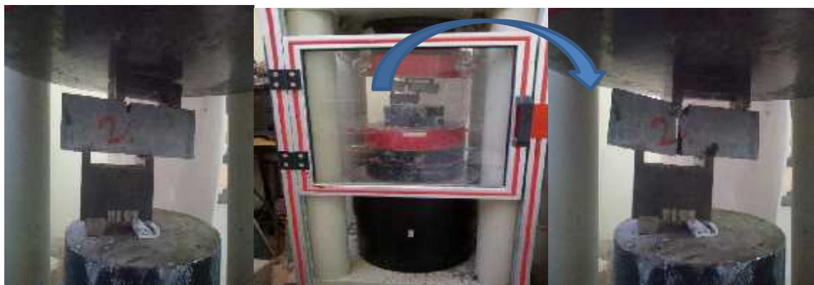
Figure III.19: Dispositif de rupture en cisaillement par compression [Laboratoire UR-MPE/FSI-Boumerdes]
