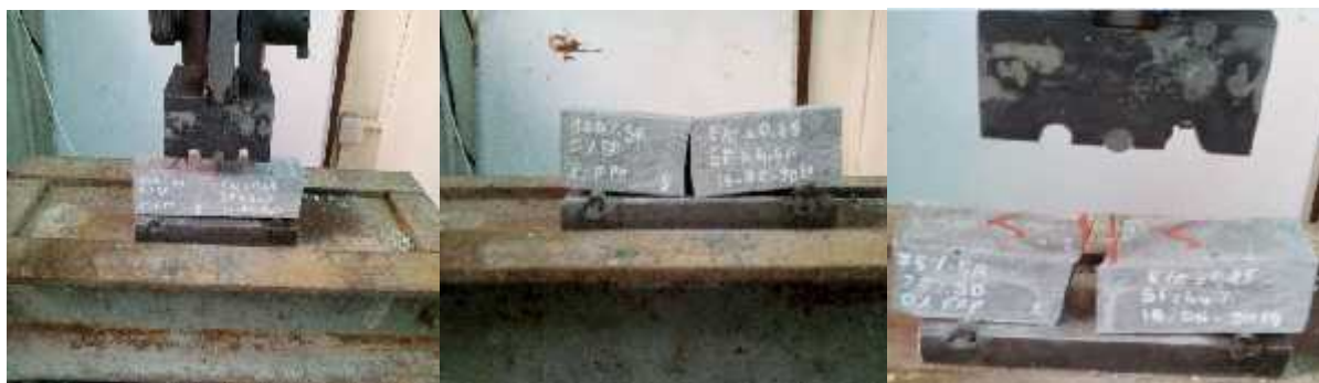
a. Dispositif de l'essai b. Flexion 3pts 1%FPP- c. flexion 3pts 0%FPP
