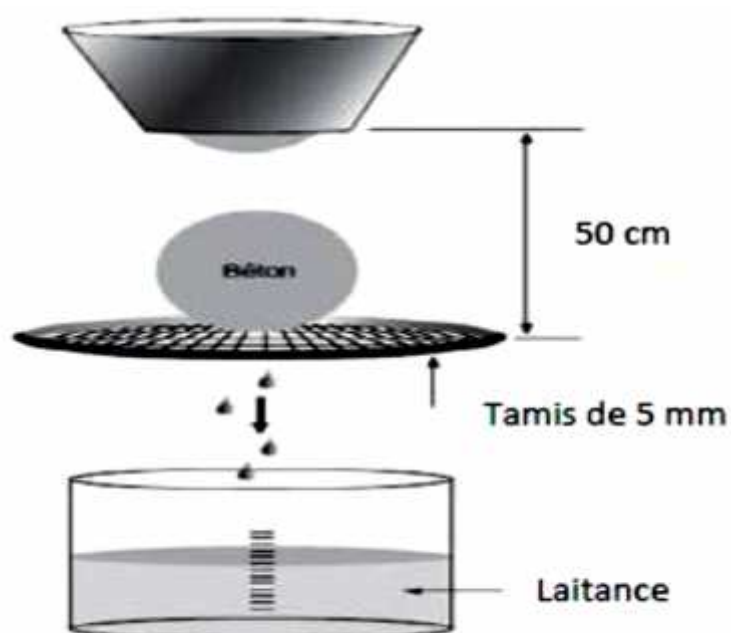
Figure I. 12 : Procédure d'essai de la stabilité au tamis [12]
