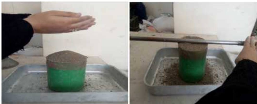
Figure III-4 : Essai de détermination de la masse volumique apparente du sable
