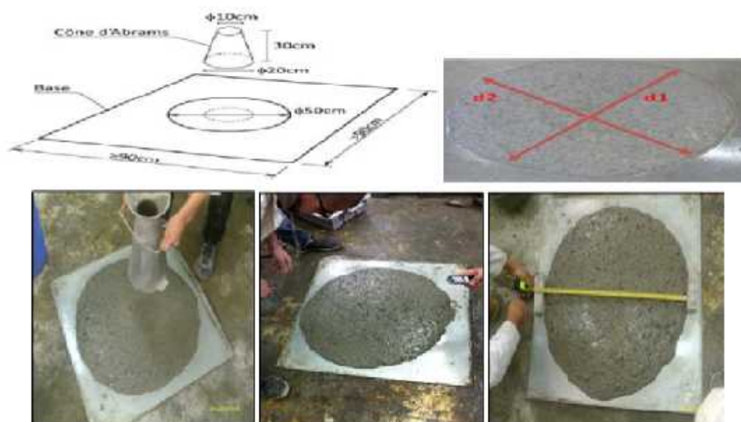
Figures I.9 : Essai d'étalement pour les BAP [14] [15]
