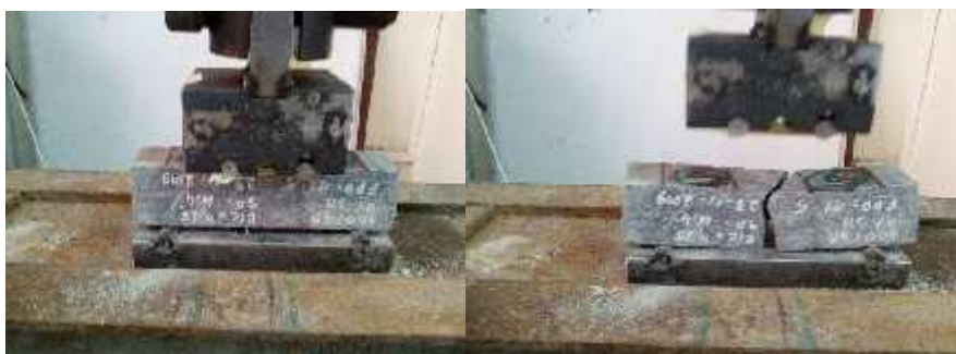
Figure IV.7 : Etat de l'éprouvette après l'essai de flexion 4 points
