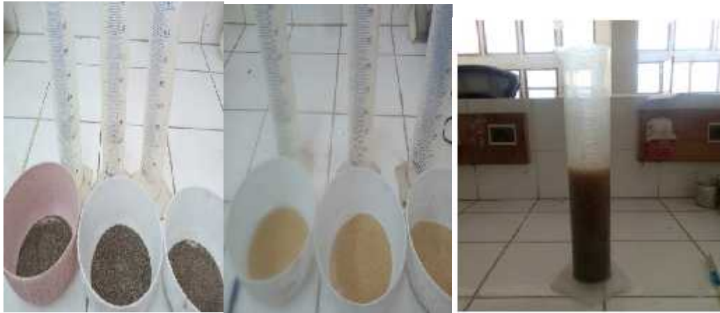
Figure III.3 : Essai de la détermination de la masse volumique absolue du sable.
