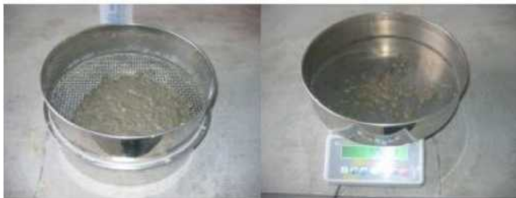
Figure I-11 : Essai de stabilité au tamis [15]
