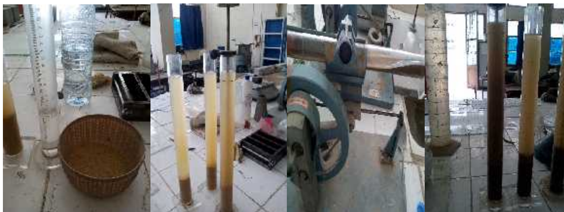
Figure III.5: Equivalent de sable pour les deux types de sables
