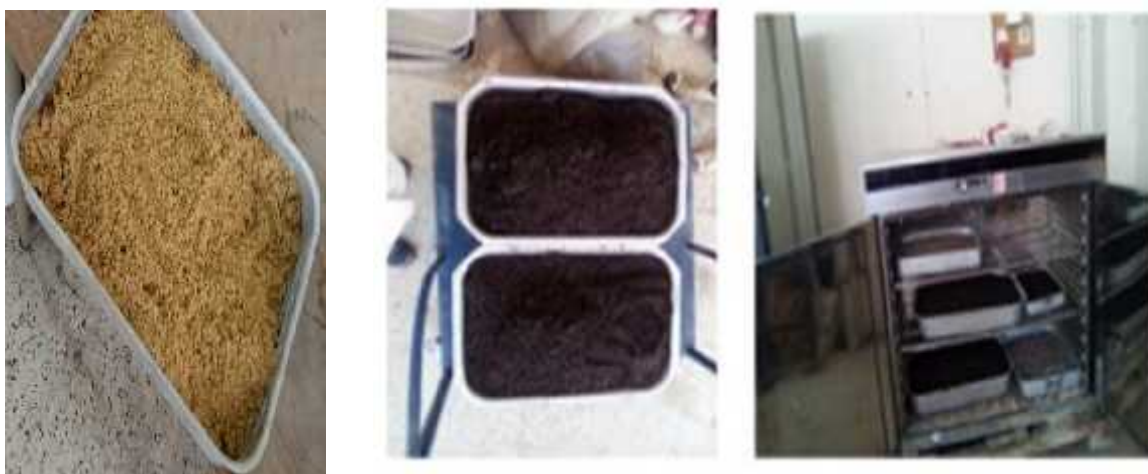
Figure III.2 : Lavage et séchage des granulats utilisés dans les différentes formulations du béton
