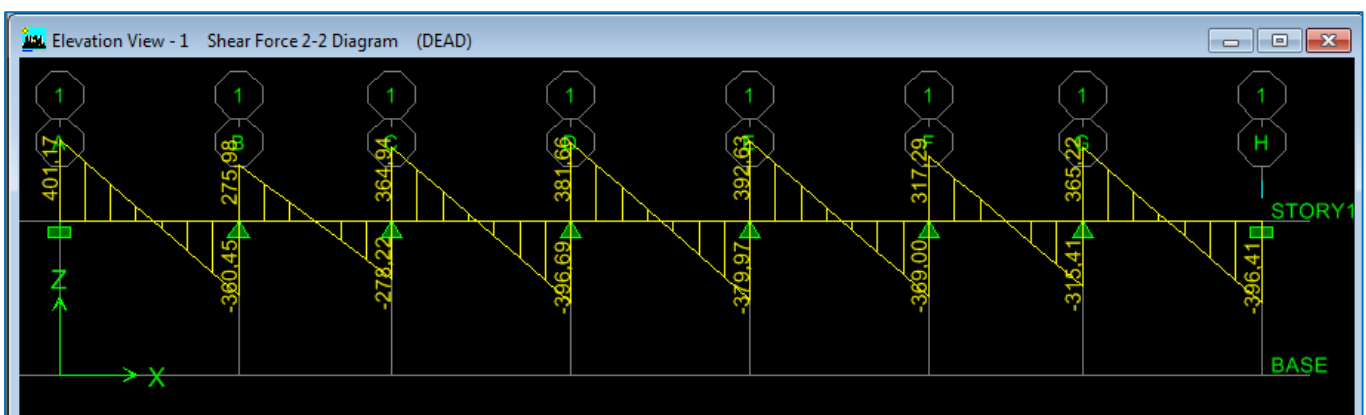
Figure VII.25 : diagramme de l'effort tranchant à l'ELS (sens transversal).
