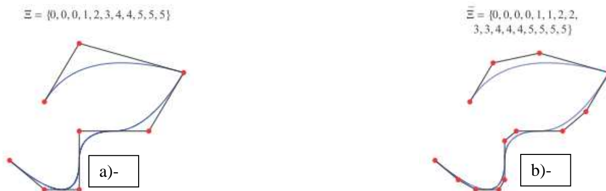
Figure (I-26) un exemple illustrant le concept de p -raffinement a)- courbe originale b-) courbe raffinée avec p -raffinement
