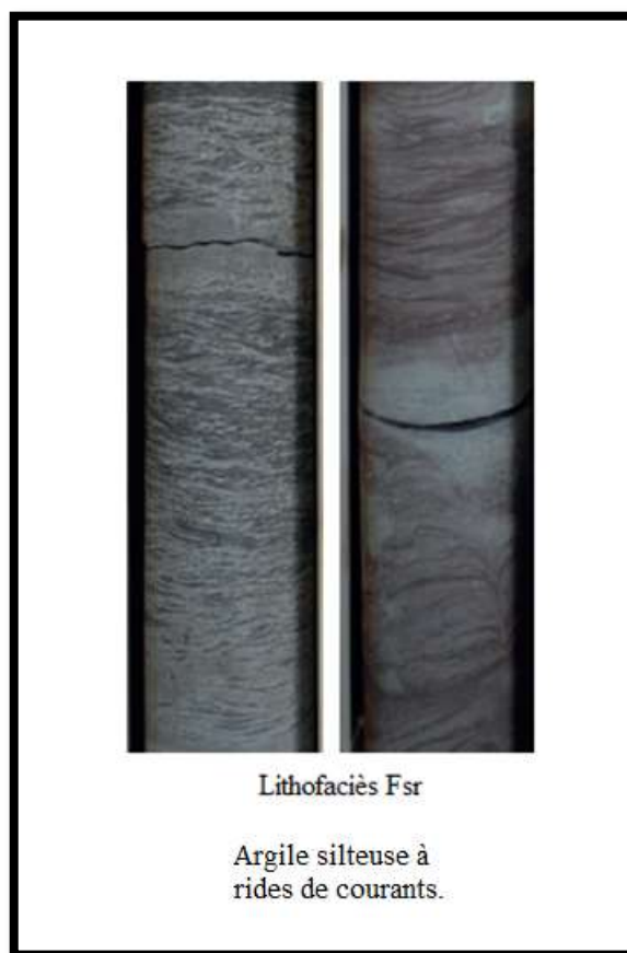
Figure II- 10 : Photos de carottes montrant les différents lithofaciès rencontrés dans les levées.
