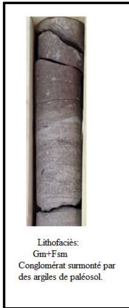
Figure II- 12 : Photos de carottes montrant les différents lithofaciès rencontrés dans les chenaux abandonnés.
