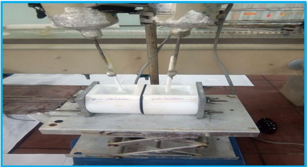
Figure III.2. Dispositif d'étude du transport d'ion métallique à travers une MLS.
