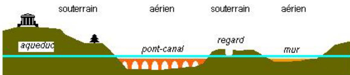
**Fig. 2.19** : l'aqueduc en forme canal, tunnel, mur porteur
