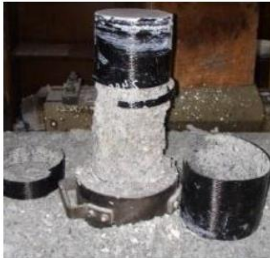
Figure III.25 : Modes de rupture des colonnes confinées avec CFRP[41]
