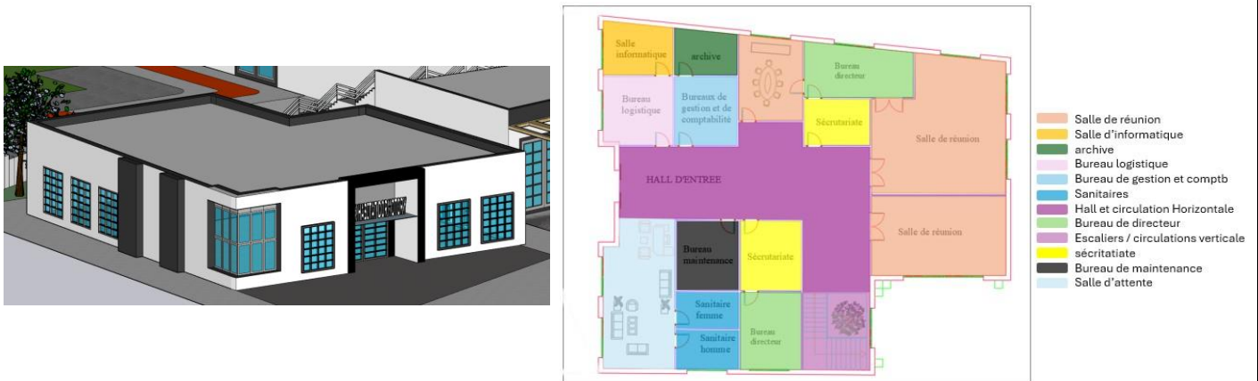
Figure 193 : Entité administrative de la résidence après l'intervention.
