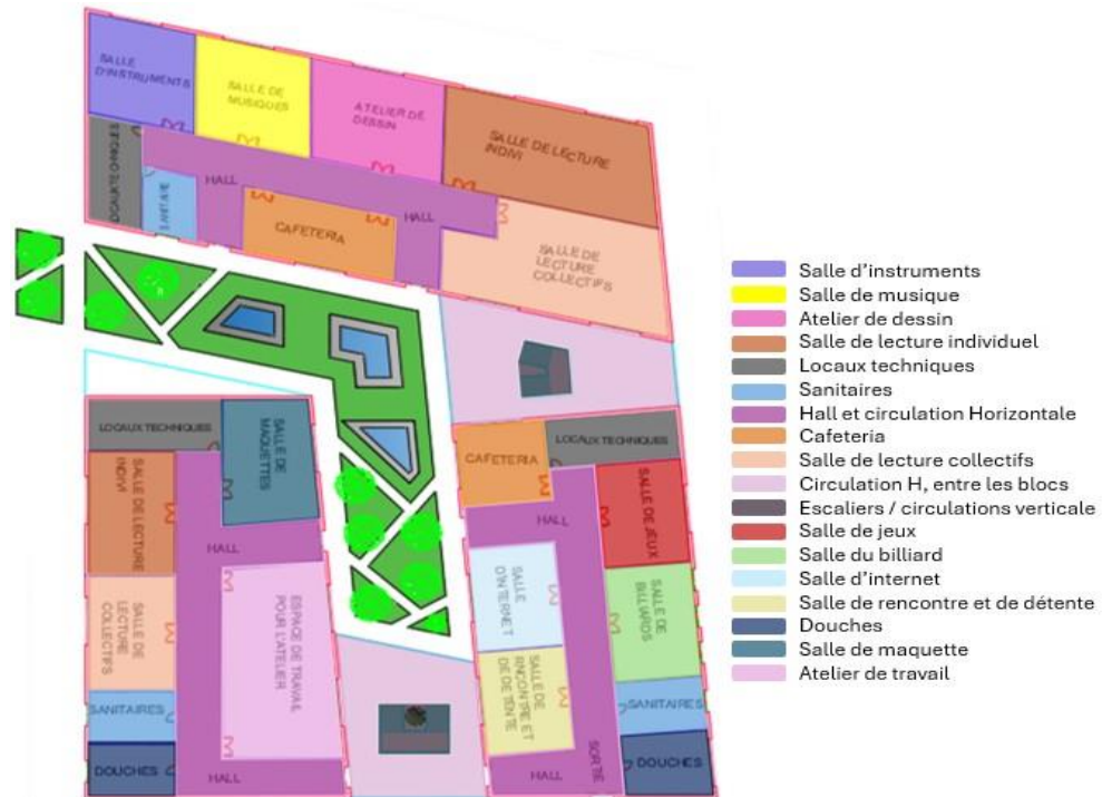
Figure 195 : plan des blocs résidentiels après l'intervention.
