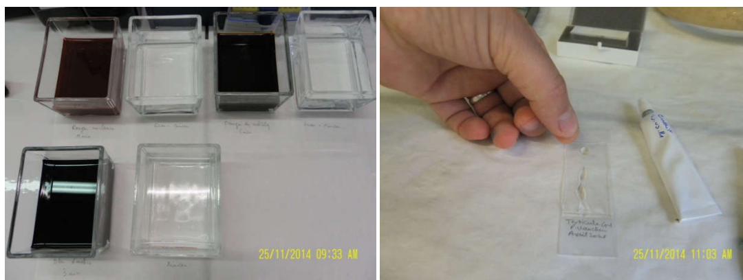
Figure 22: Méthode de coloration (à gauche) et montage des lames à l'Eukitt (à droite).
