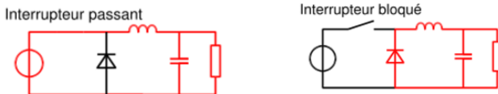
Figure (II.6): Les deux configurations d'un convertisseur Buck suivant l'état de l'interrupteur.
