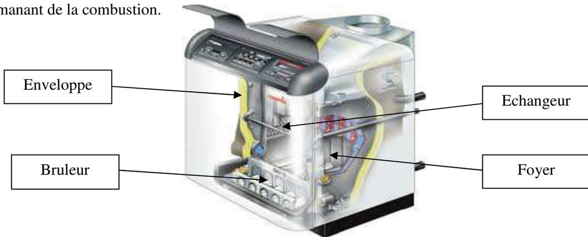
Figure 1.8 : Image descriptive d'une chaudière
