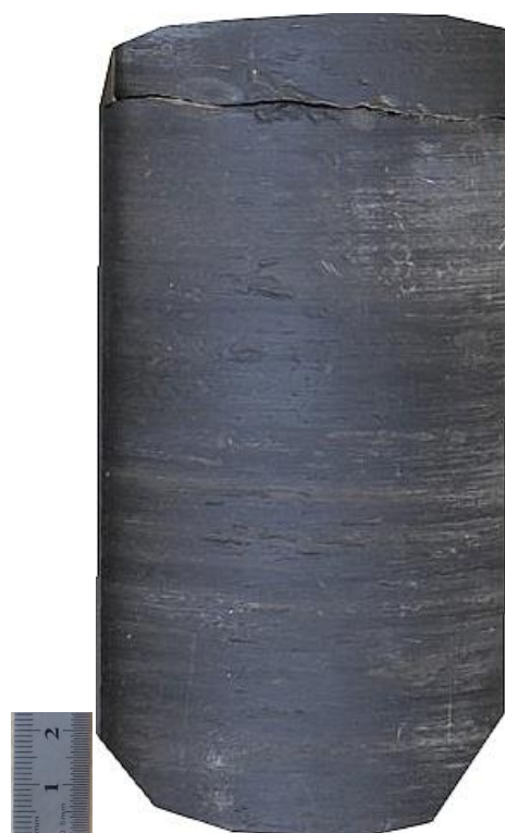
puits RF-1 (3821.5) Argile noire d'offshore.
