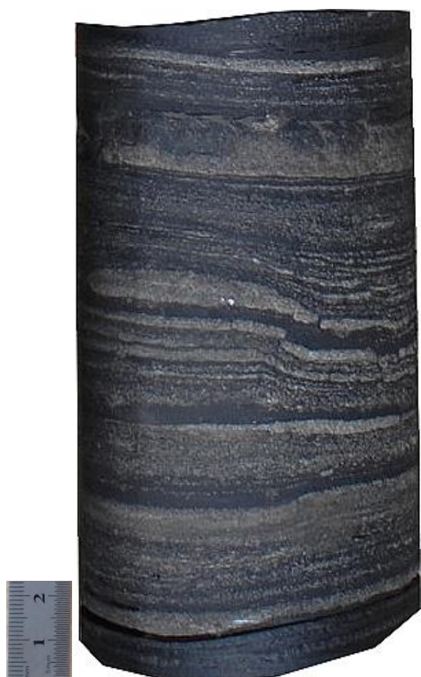
puits RF-1 (3816.75) Argile noire, silteux.
