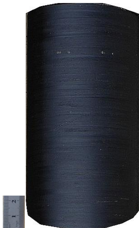
puits RF-1 (3819) Argile noire, avec passage de grés fins.
