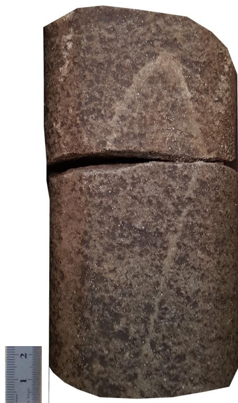
NA-4 (3995.5) Fracturation comblé par de la silice
