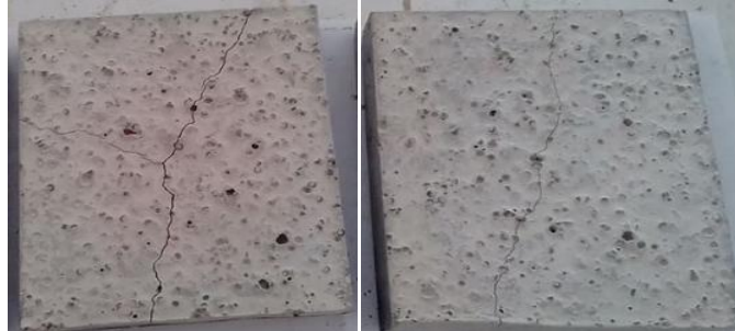
Figures III.14. Etat d'endommagement des dallâtes à forte teneur en GC après rupture.
