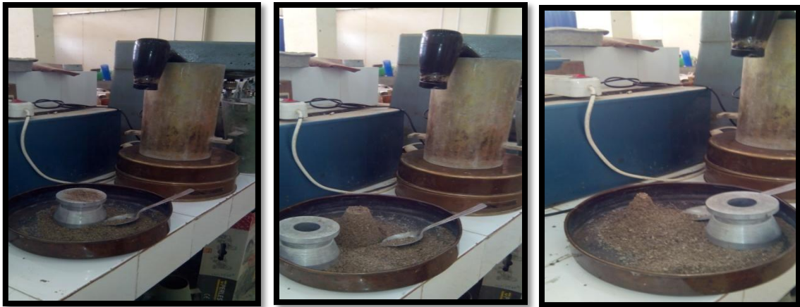
Figure I.6. Différents étapes de détermination de l'absorption du sable
