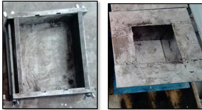
Figure II.3. Moules utilisés pour la confection des deux sortes d'éprouvettes.
