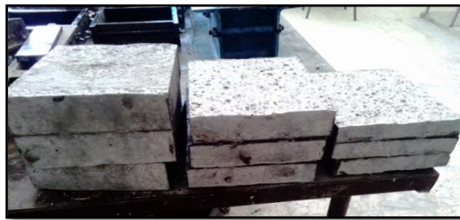
Figure II.6. Les différentes dalles après décoffrage
