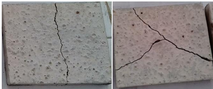
Figures III.15. Etat d'endommagement des dallâtes de bétons à faible teneur en GC après rupture.
