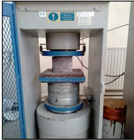
Figure II.5. Presse de mesure de la compression uni-axiale
