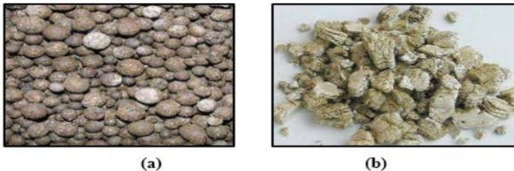
Figure I.2. Illustration des granulats expansés : a) Argile ; b) Schiste
