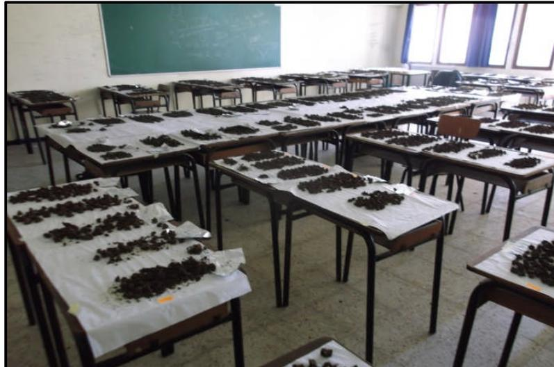
Figure14 : séchage des sols échantillonnés (Gx1)
