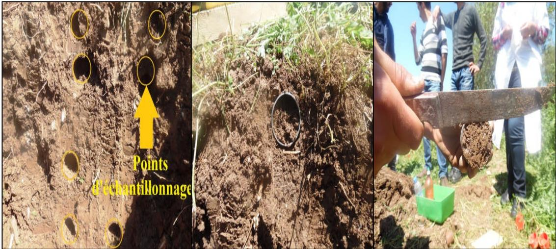
Figure 15: Mesure de la densité apparente par la méthode du cylindre
