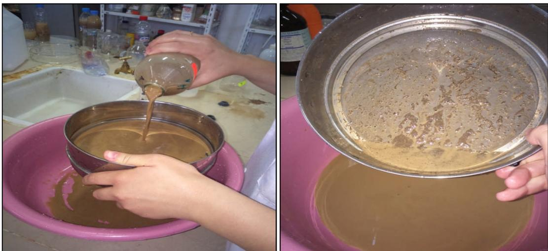
Figure16 : tamisage et séparation des 2 fractions de sol (fractions  $<50\mu\text{m}$ , fractions  $>50\mu\text{m}$ ).
