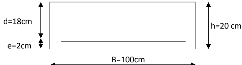
Fig 3.5 : Schéma statique de ferrailage d'escalier à l'ELU.
