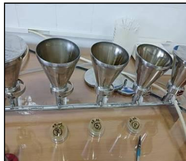
Rampe de filtration
