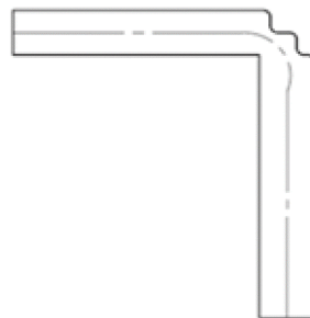
Figure II.35 : Déformations à un angle vif ( R=0 ).
