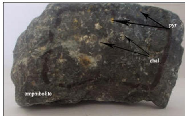
**Fig. V.6 : Pyrite et chalcopryrite disséminées dans les amphibolites**
