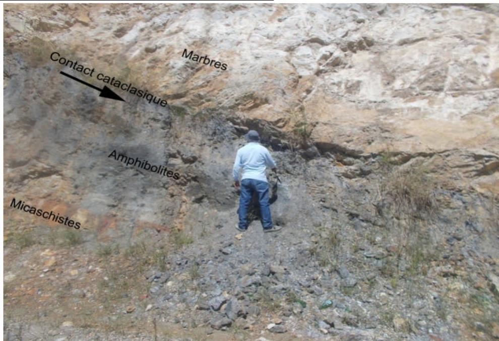
**Fig. IV.30 : contact cataclasique entre les marbres et micaschistes-amphibolites de direction N150°.**
