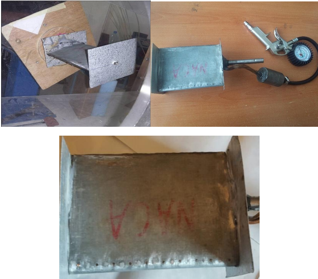
Figure 4.35 : Nouvelle maquette n° 2 montée sur la Balance aérodynamique.
