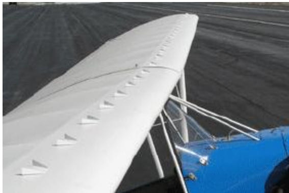
Figure 3.5 : Illustration d'un générateur de vortex passif type Tabs, installés sur Stewart Headwind[2].
