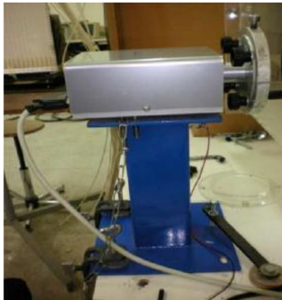
Figure 4.5 : Photo de la balance aérodynamique utilisée.
