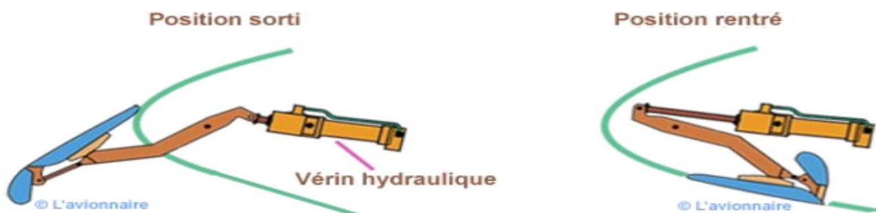
Figure 1.20 : Principe de fonctionnement du volet de Kruger.
