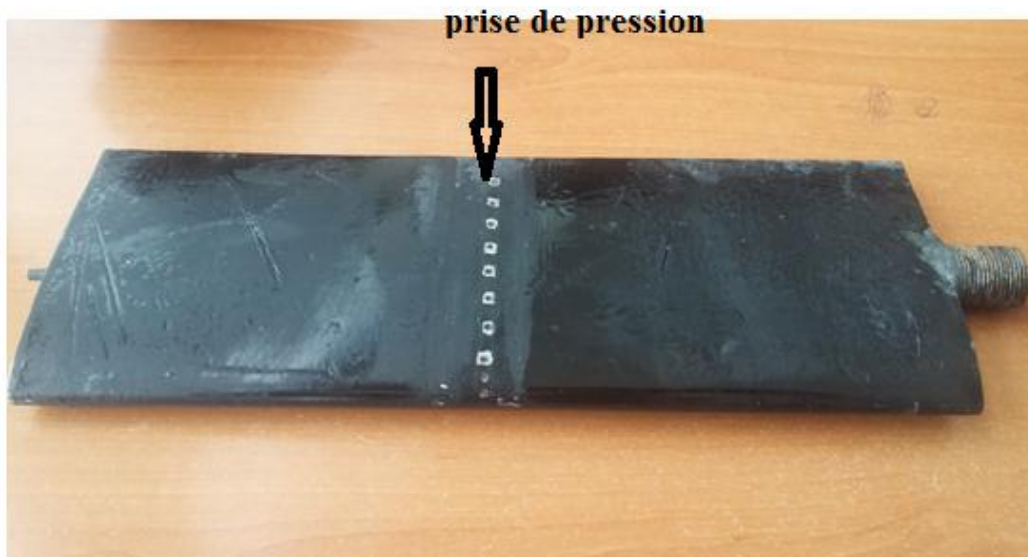
Figure 4.16 : Maquette n°1 à profil NACA0015 fini.
