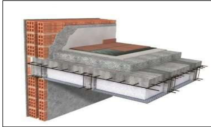
Figure II.4. Plancher étages courants
