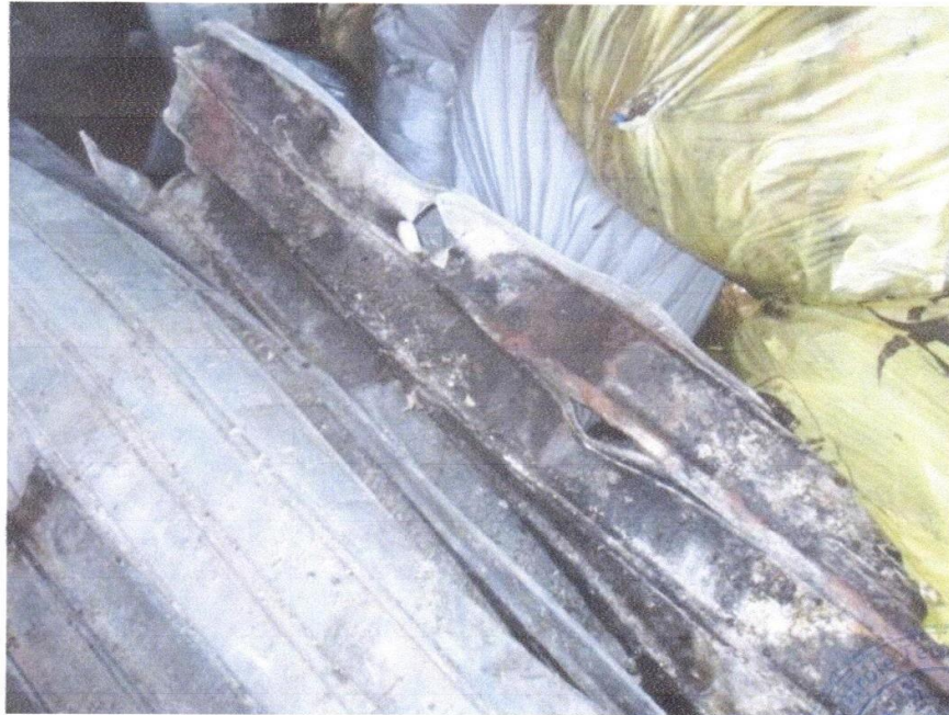
Photos à l'intérieure du locale montrant l'ampleur des dommages constatés sur les rideaux métalliques à commande électrique
