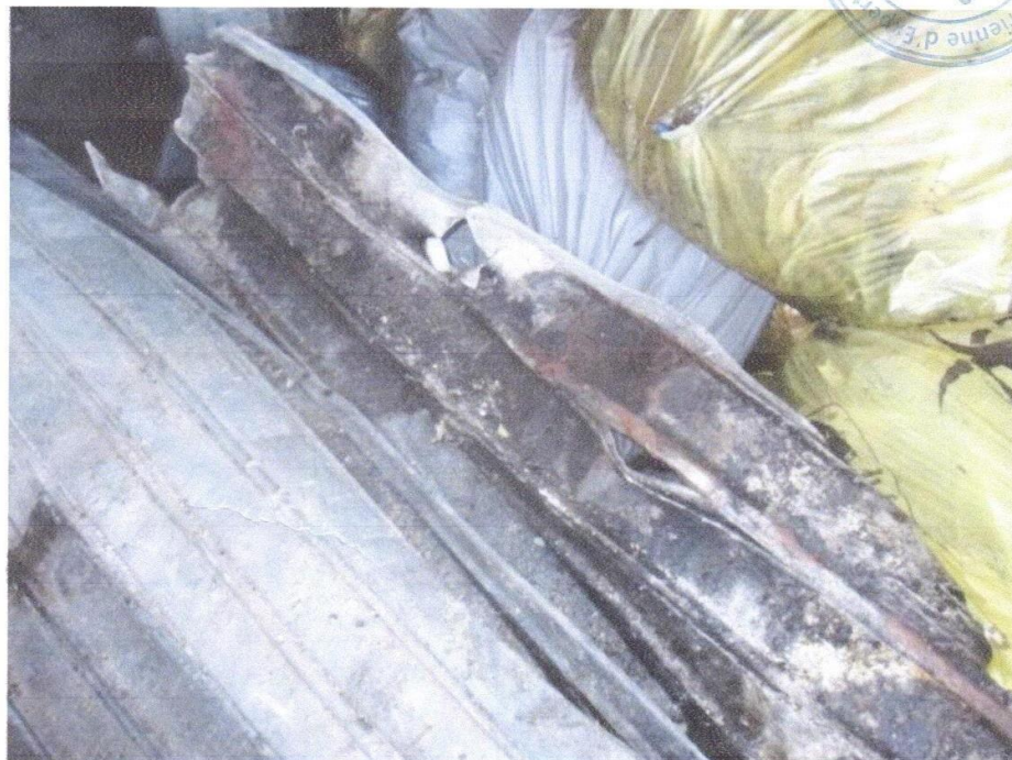
Photos à l'intérieure du locale montrant l'ampleur des dommages constatés sur les rideaux métalliques à commande électrique
