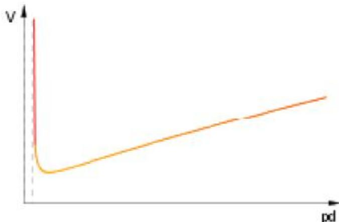
**FIGURE I.2. Courbe de Paschen, en abscisse le produit pression distance, en ordonnée la tension**
