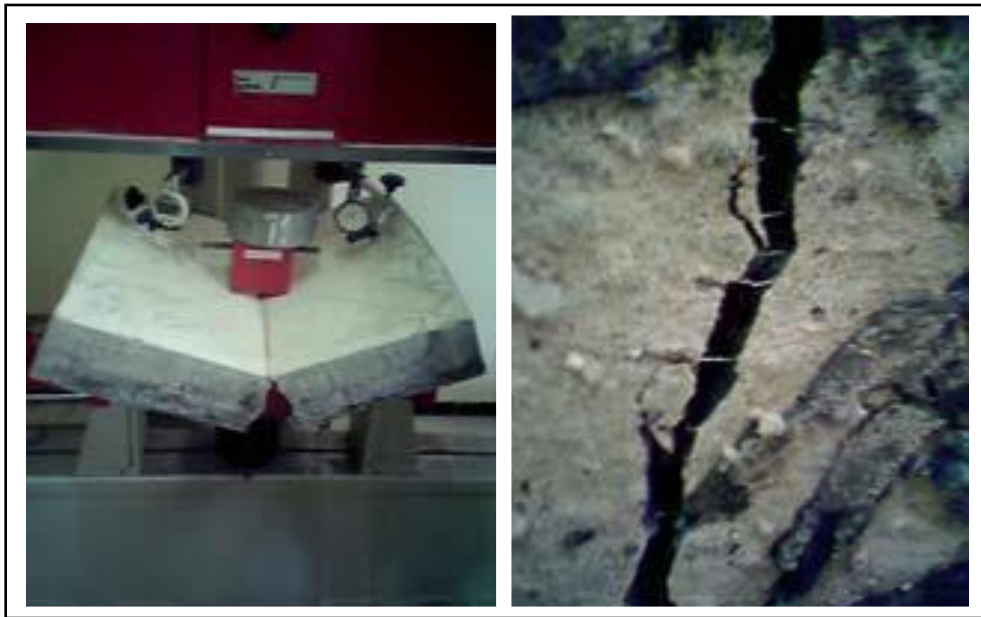
Figure I.40 La ligne de rupture est inclinée par rapport au milieu de la dalle à un angle inférieur à 45^\circ pour les dalles en béton de fibres métalliques et au milieu pour les dalles sans fibres [95].
