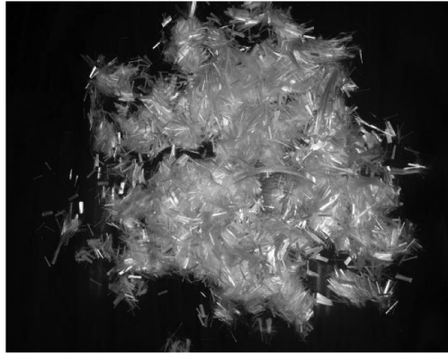
Figure. I.50 Type de fibre de polypropylène [102].
