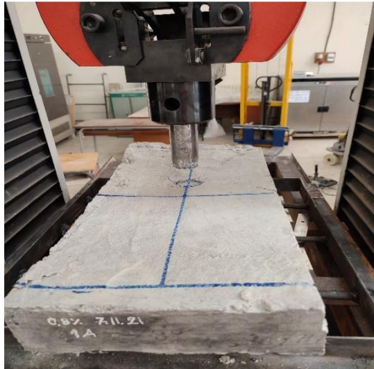
Figure IV.11 Exemple de l'essai de poinçonnement excentré.
