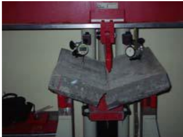
Figure I.39 Ligne de rupture est au milieu de la dalle [95].
