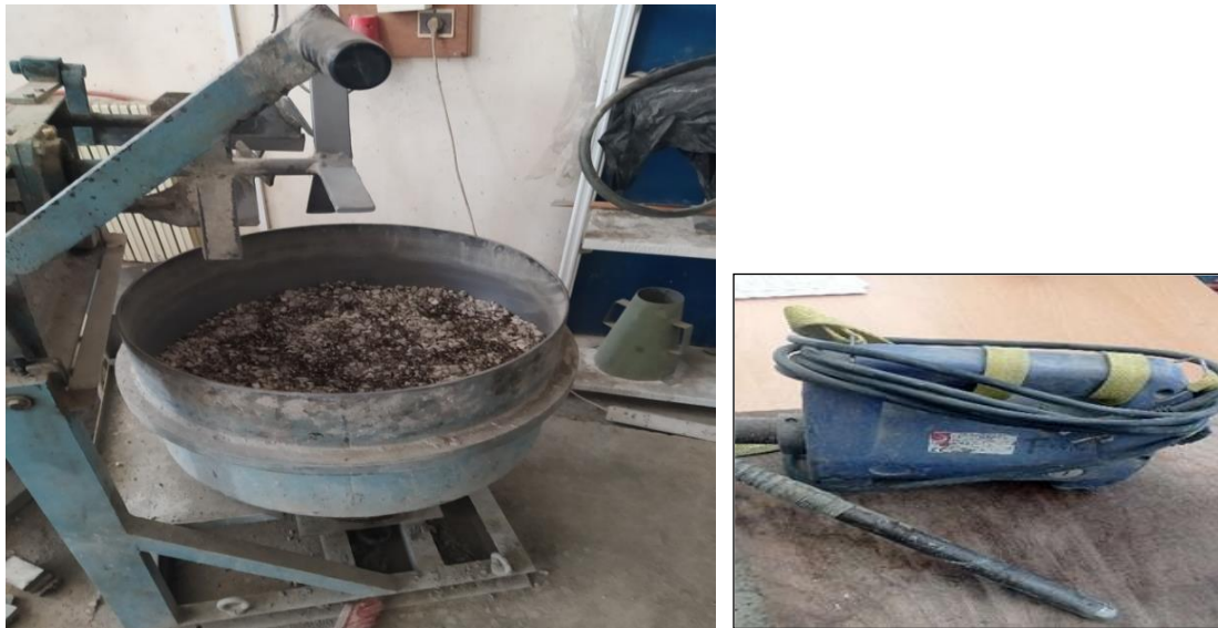
Figure III.3 Malaxeur à axe vertical de capacité 65 litres et le vibreur employé.
