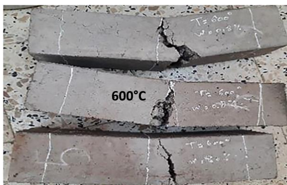
Figure IV. 34 Exemple des poutres testées à 600°C.
