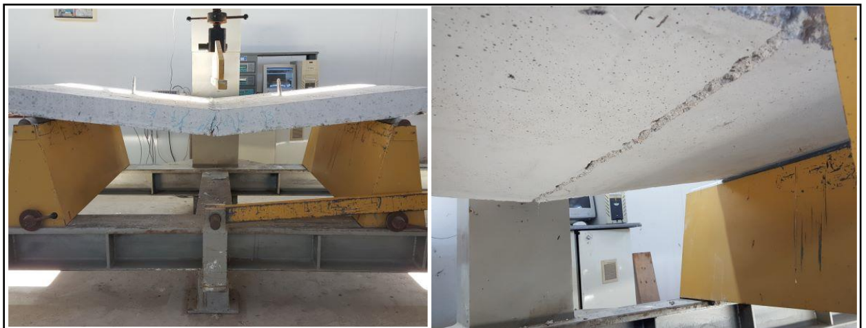
Figure I.28 Endommagement des dalles SS après chargement [90].
