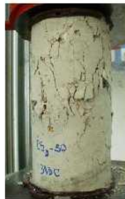
Béton CS3-30 après cycle de chauffage-refroidissement de 300°C.
