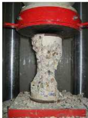
Béton CP3-2 après cycle de chauffage-refroidissement de 300°C.
