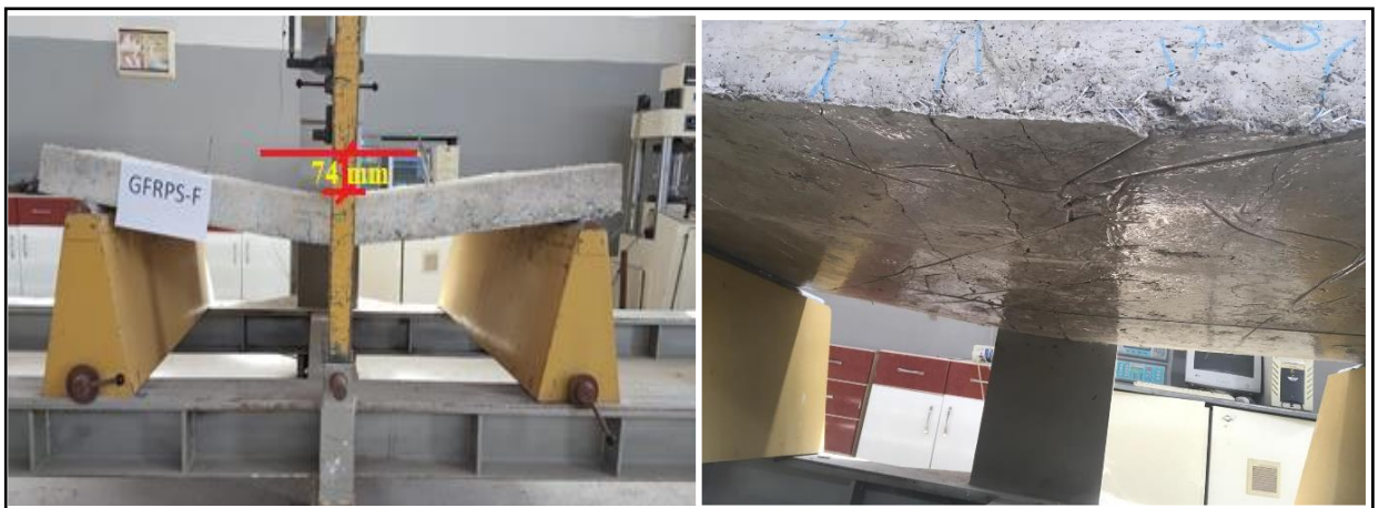
Figure I.27 endommagement des dalles GFRPS-F après chargement [90].
