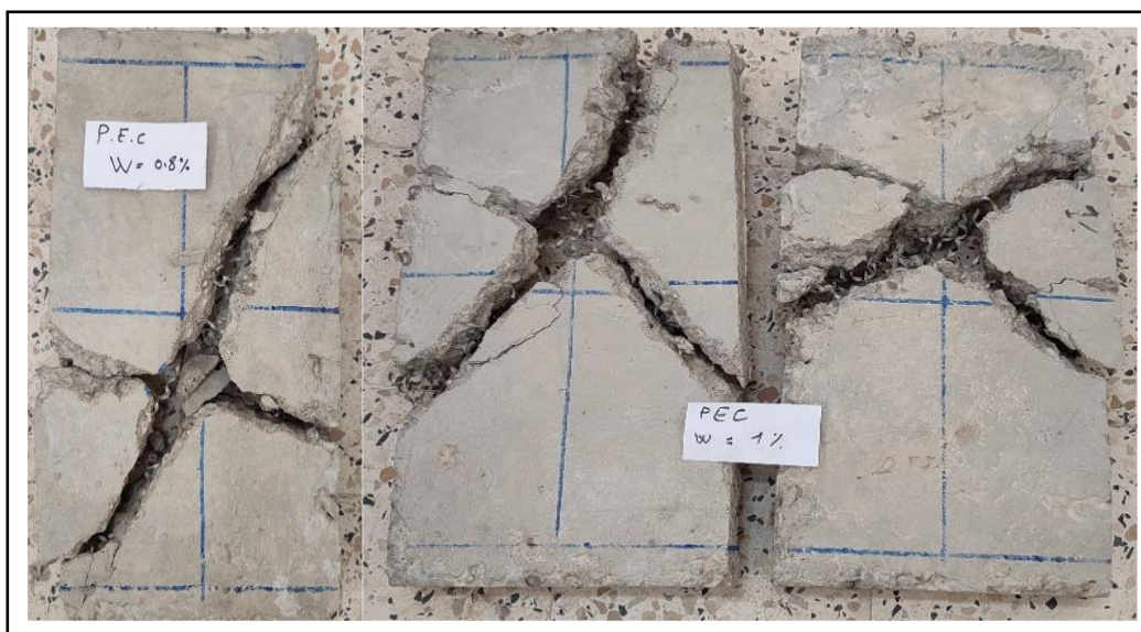
Figure IV.12 Modes de rupture des dalles renforcées par des fibres métalliques sous un chargement de poinçonnement excentré
