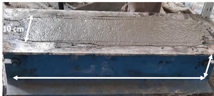
Figure. IV. 31 Moules prismatiques utilisés.
