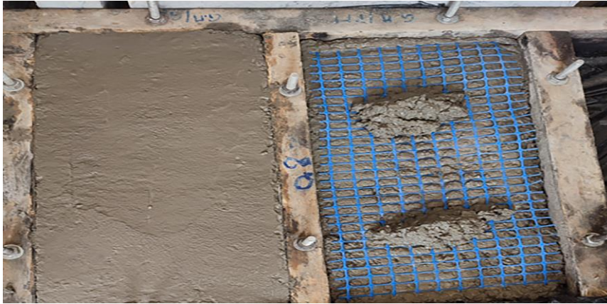
Figure III.1 Coffrage des dalles utilisées.
