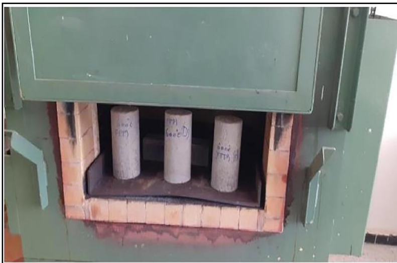
Figure IV.22 Disposition des éprouvettes à l'intérieur du four.
