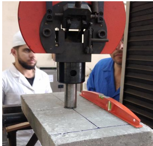
Figure IV.2 Essai de poinçonnement centré.
