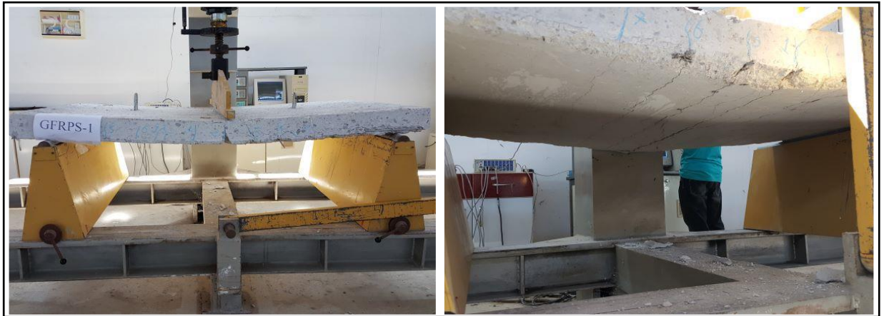
Figure I.26 endommagement des dalles GFRPS après chargement [90].
