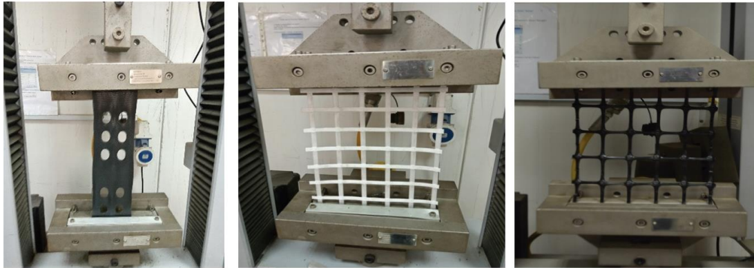
Figure. I.51 Essai Geogrid en utilisant la méthode de traction multi-nervure [102].
