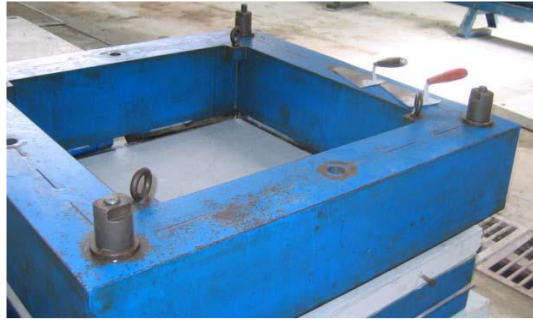
Figure I.42 Dispositif métallique en quatre appuis [95].
