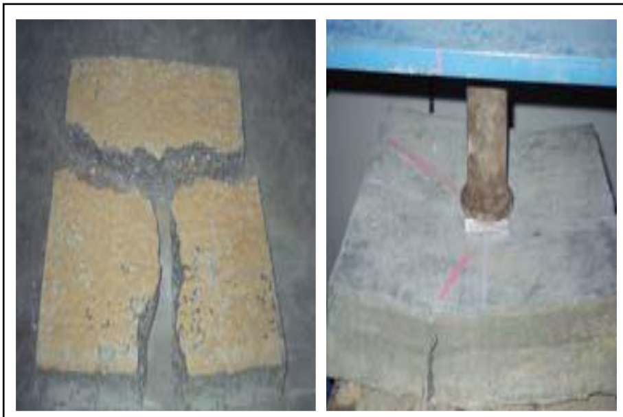
Figure I.41 Deux lignes de rupture perpendiculaires et inclinées par rapport au milieu de la dalle à un angle inférieur à 45^\circ pour les dalles en béton de fibres métalliques et deux lignes de rupture perpendiculaires au milieu pour les dalles sans fibres [95].
