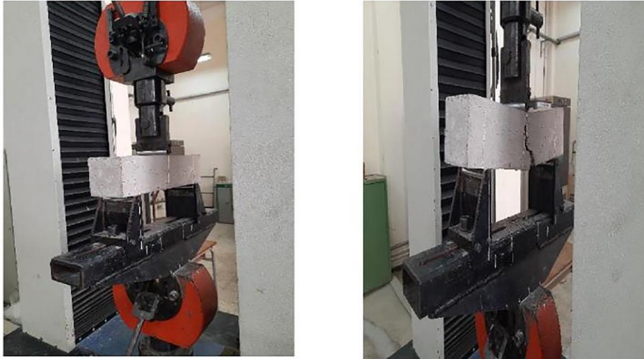
Figure IV. 32 Dispositif de l'essai flexion 3 points.
