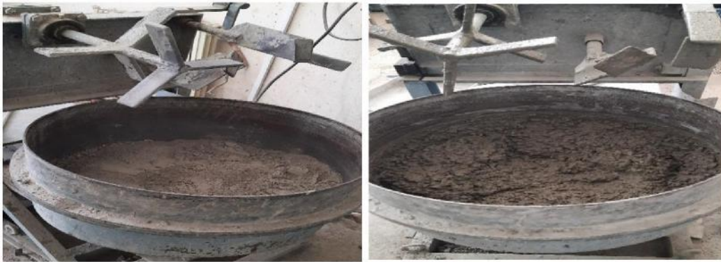
Figure IV. 19 Malaxage de béton.
