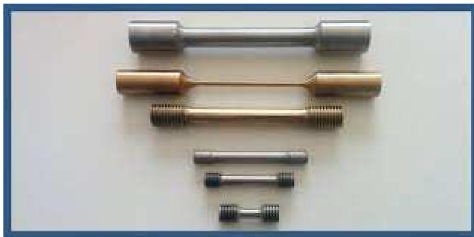
*Fig. I.23 : Types d'éprouvettes cylindriques.*
