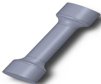
**Fig. I.22** : Eprouvette cylindrique.
