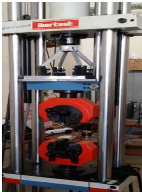
*Fig. III.27 : fixation de l'appareil sur la machine de traction.*
