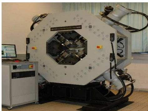
*Fig. I.16 : Système de traction biaxial Scholz et al.,2000.*
