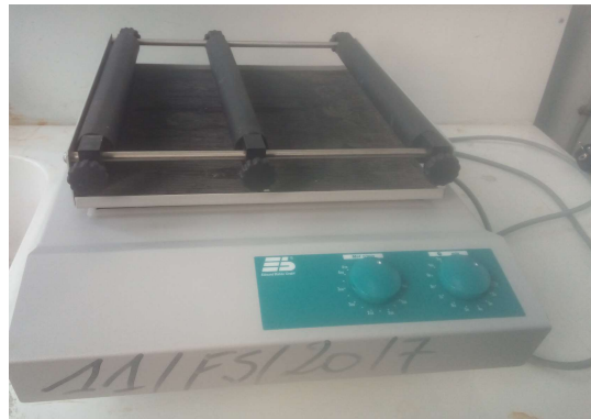
Figure II.2: Agitateur mécanique va et vient utilisé dans les expériences d'adsorption.
