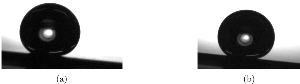
Figure 4.10 – Début de glissement d’une goutte d’eau sur un dépôt réalisé avec 100 cycles de 8 secondes (a) et de 4 secondes (b).
