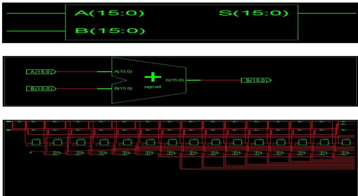
Figure (IV.04): Vue externe, interne (*RTL*) et technologique du module additionneur à 16 bits.
