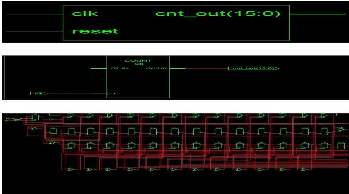
Figure (IV.18):*Vue externe et interne(RTL) du module de conteur d’impulsions à 16 Bits.*
