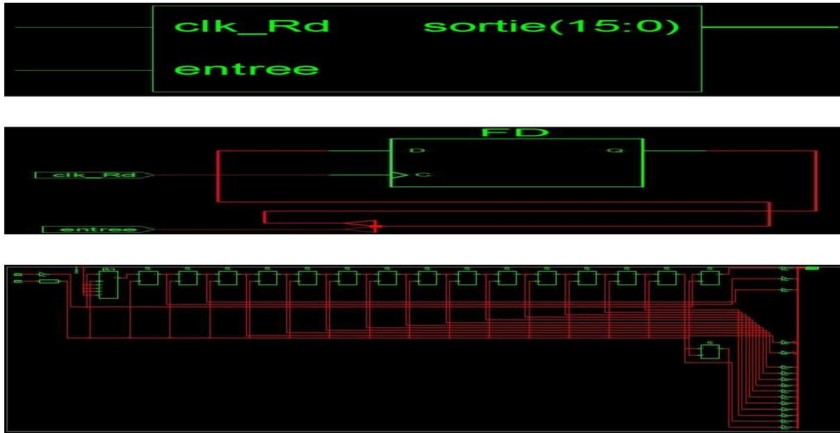
Figure (IV.14):Vue externe, interne(RTL) et technologique du module registre à décalage a 16Bits.
