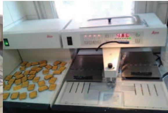
**Figure 19:** Automate de confection des blocs de paraffine (**Original**)
