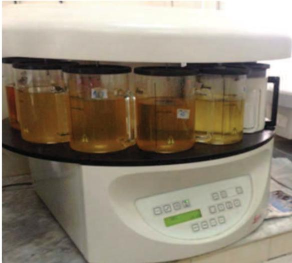
**Figure 18:** Automate de déshydratation (**Original**)
