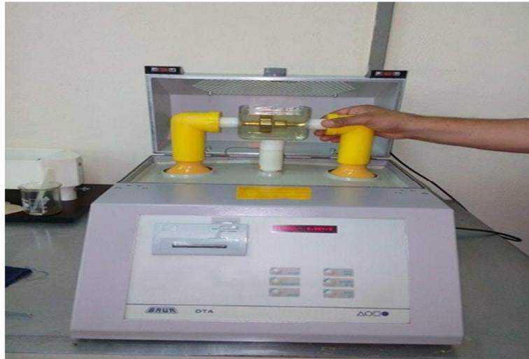
Figure III.6. Spintermètre
