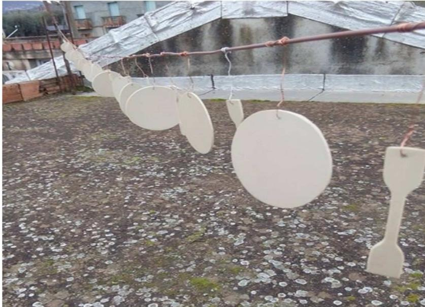
**Figure III.3.** Échantillons de l'EPDM exposés à l'air libre.
