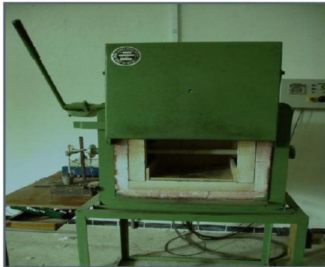
Figure33 : Four des traitements thermique
