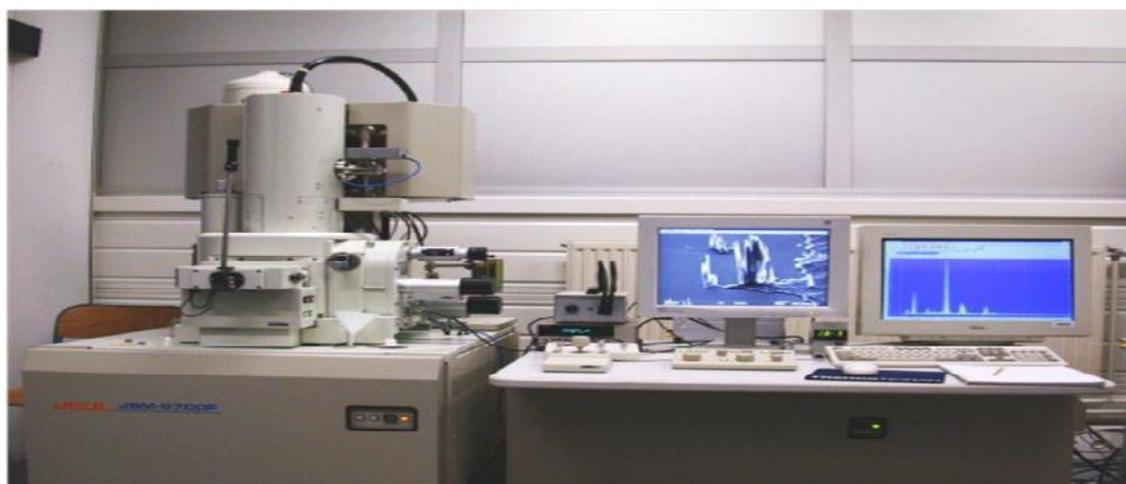
Figure38 : Microscope électronique à balayage (MEB)
