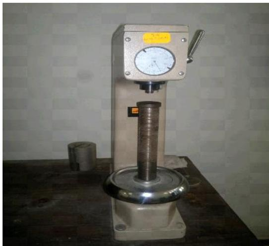
Figure34 : Duromètre pour les essais de dureté
