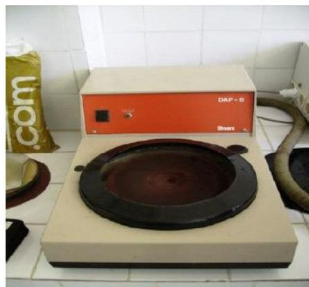
Figure37 : Polisseuse de finition
