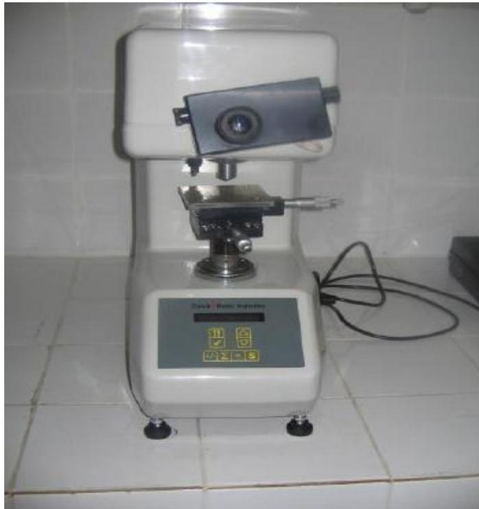
Figure 40 : le microdromètre
