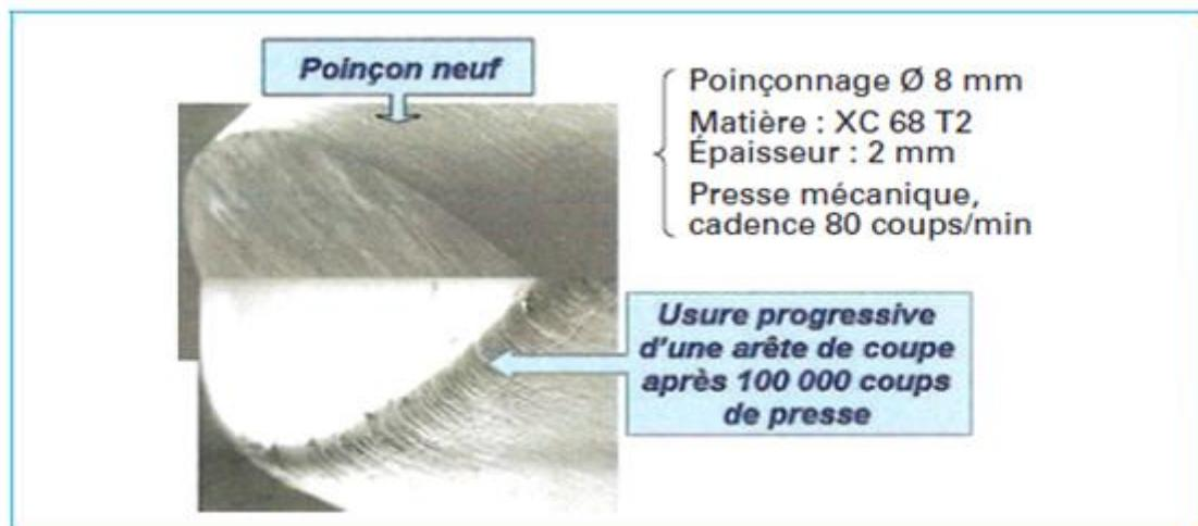
Figure 28 : Aspect de l'arête de coupe d'un poinçon avant et après usure progressive [11]
