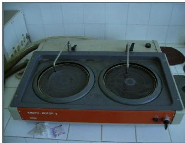
Figure36 : Polisseuse a deux disques de marque « KNUTH-ROTOR2 ».
