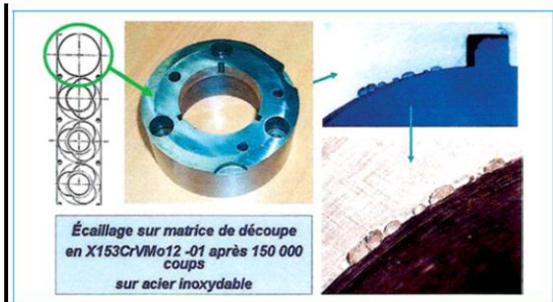
Figure 29 : Aspect de l'arête de coupe d'une matrice écaillée [11]
