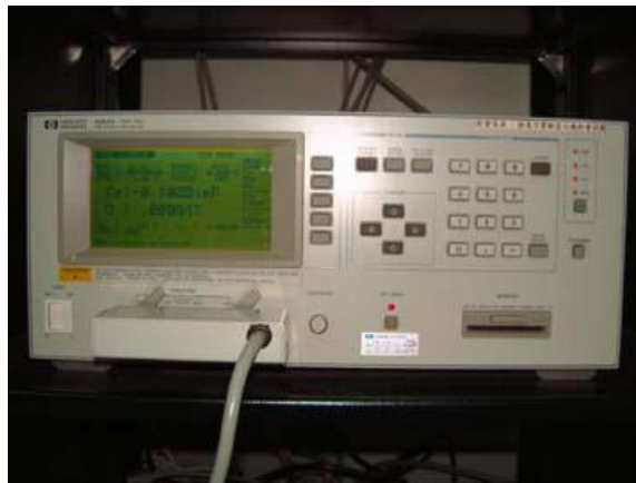
Figure II. 8 : Impédancemètre HP 4284A.
