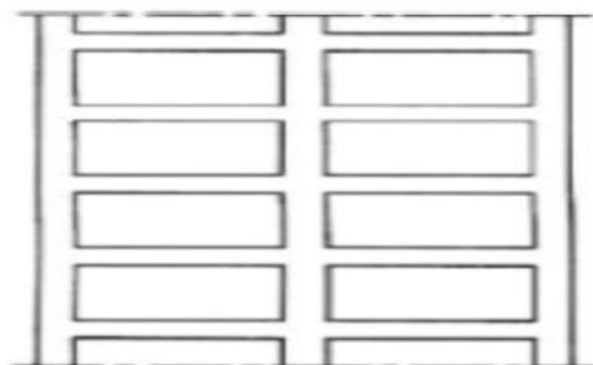
Figure II.9: Les ossatures en portiques.
