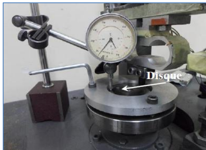
Figure III-4. Réglage de planéité lors du montage du disque.
