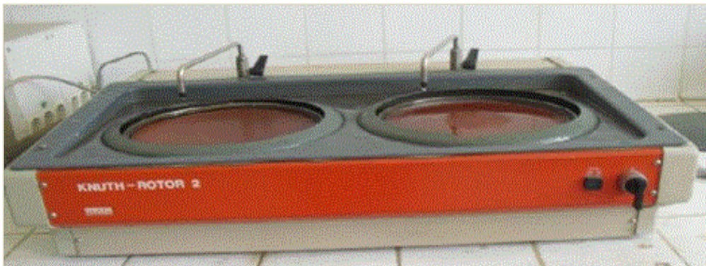
Figure III-14. Polisseuse de marque KNUTH-ROTOR (laboratoire SDM).
