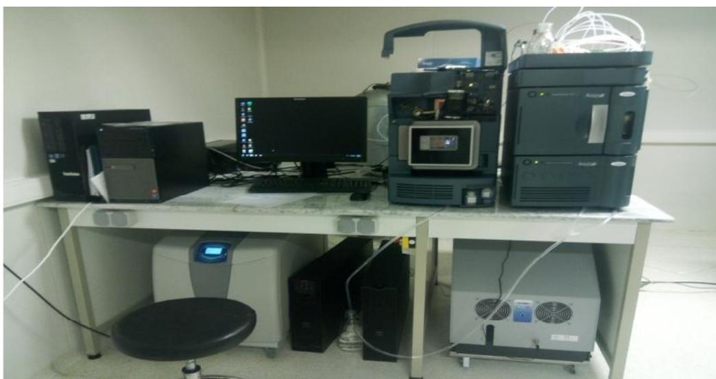
Fig N°06 : Image de l'ensemble des parties d'une chaîne UPLC MS/MS
