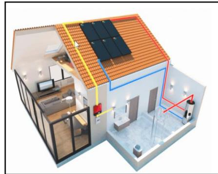
Figure 67 : Fonctionnement d'un panneau solaire hybride
