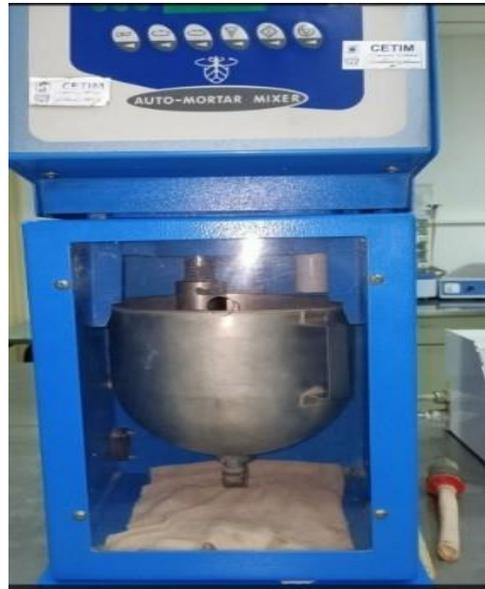
Figure IV. 12. Malaxeur mécanique auto-mortar.
