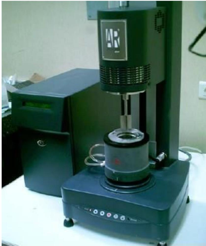
**Figure IV.7.** Rhéomètre AR2000- TA- Instruments.
