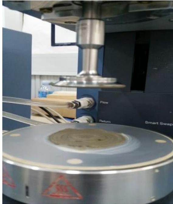
**Figure VI. 4.** Géométrie de la plaque utilisée pour les mesures des seuils d'écoulement
