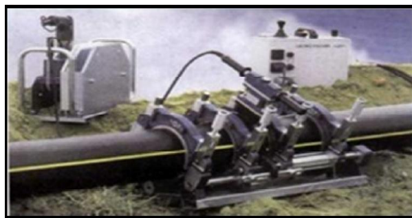
Figure IV.2 : bout à bout « bouteuse »
