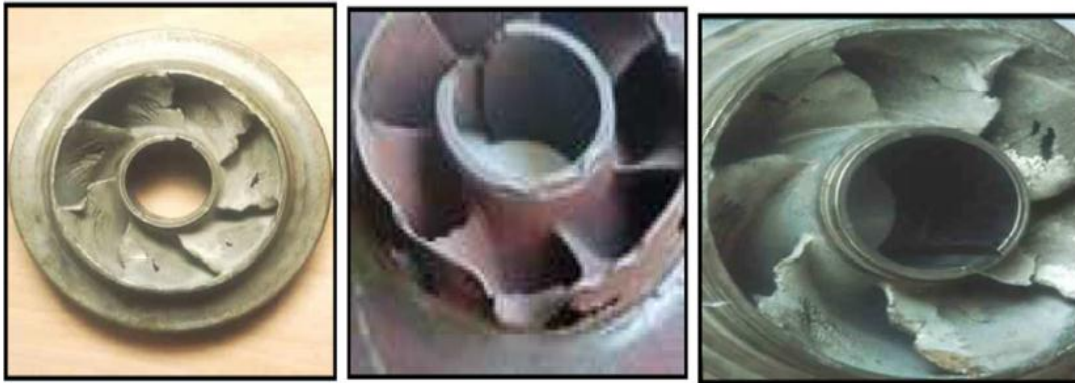
Figure VI.3: Photos illustrant le phénomène de cavitation sur des aubes de pompe centrifuge
