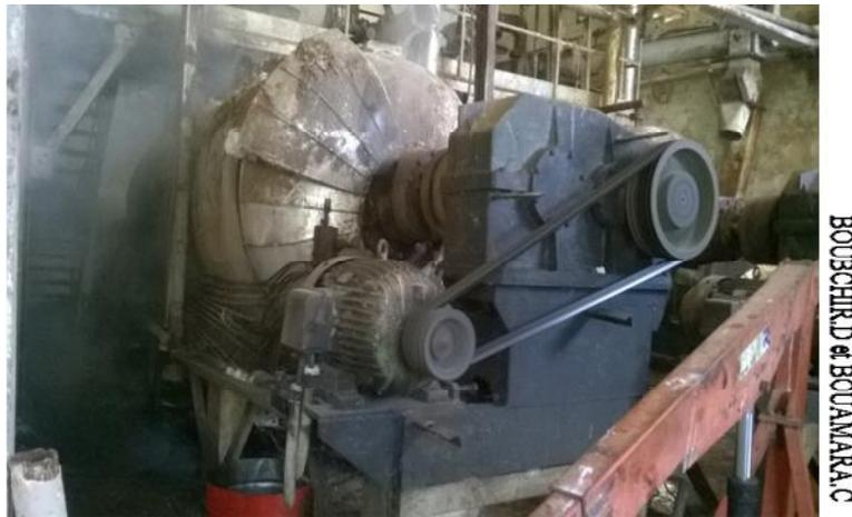
**Figure (27) :** Autoclave utilisé pour la cuisson des déchets
