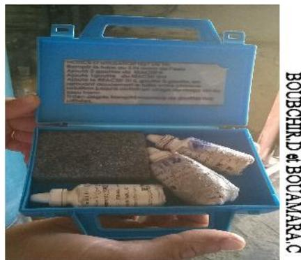
**Figure (18) :** Kit pour la mesure de la dureté de l'eau
