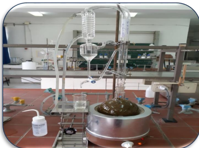
Figure II.6 : Extraction des huiles essentielles de myrte à l'aide d'un appareil type Clevenger.
