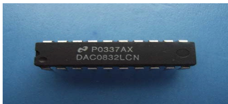
Fig.III.9 : Convertisseur numérique analogique
