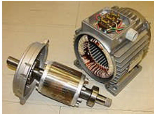
Fig. I.18 : Constitution du moteur asynchrone [8]
