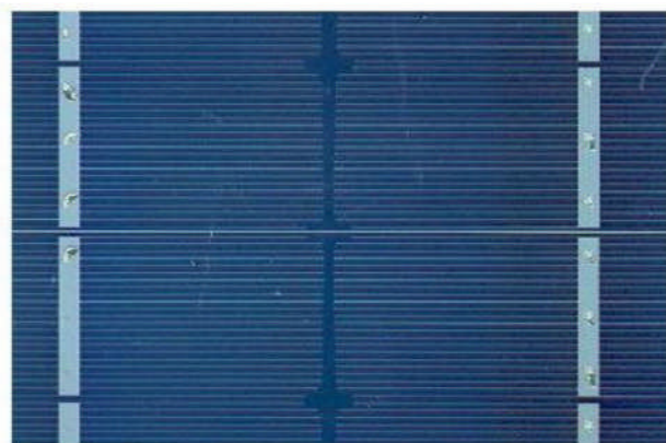
Fig. I.5 : Cellule au Silicium Monocristalline [5]
