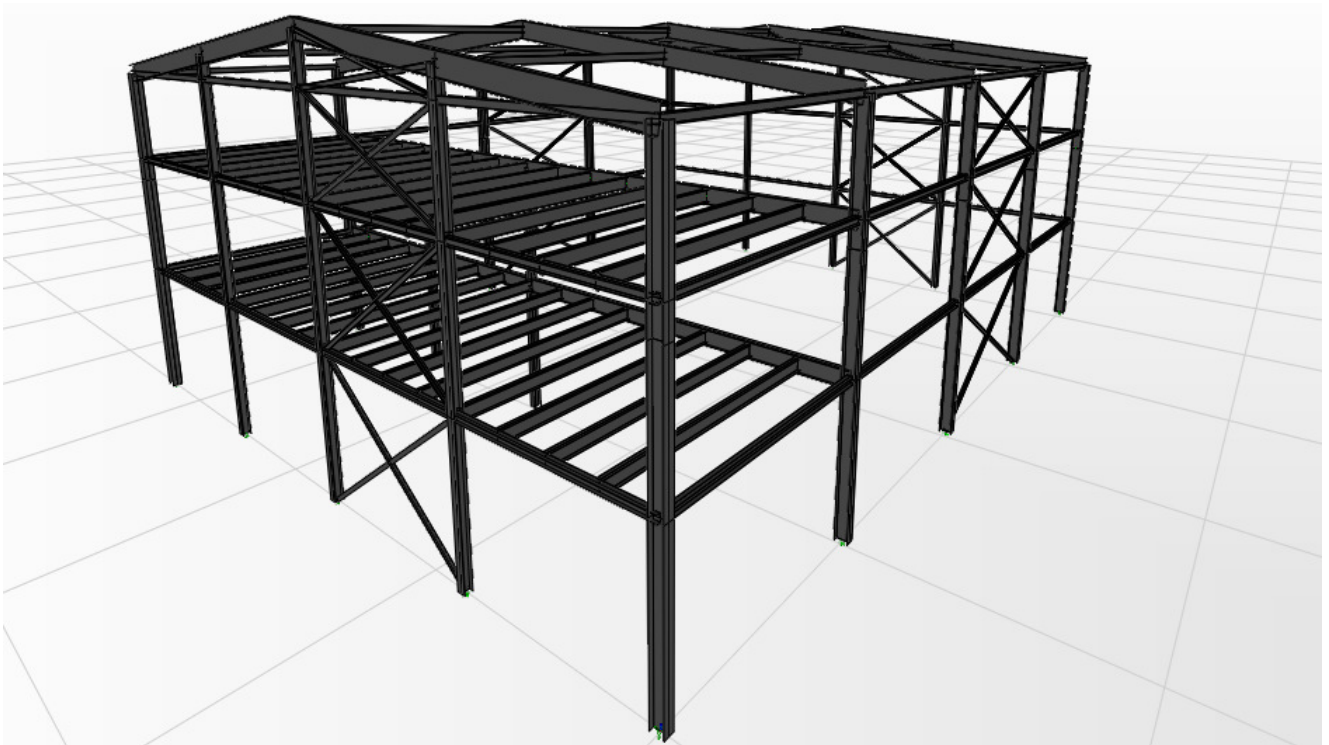
Figure VI.1 : Model numérique de la structure extrait du logiciel SAP 2000
