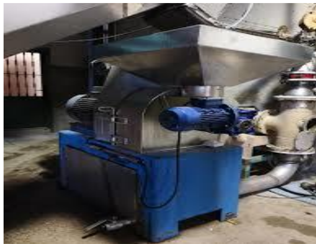
Figure 21 : Broyeur à marteaux.
