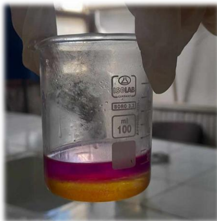
Figure 36 : détermination de l'indice de L'acidité.
