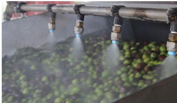
Figure 19 : Lavage des olives.
