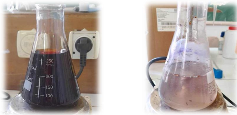
Figure 38 : Détermination de l'indice d'iode.
