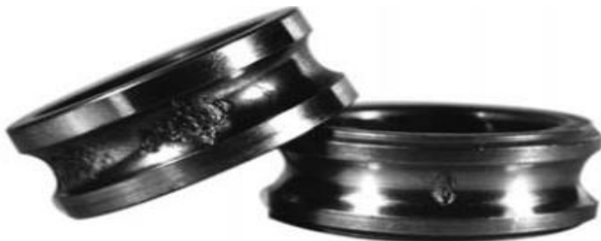
Figure III.8 : Défaut : écaillage de la bague interne
