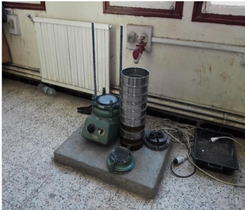
Figure III.4. Appareillage de l'analyse granulométrique par tamisage.
