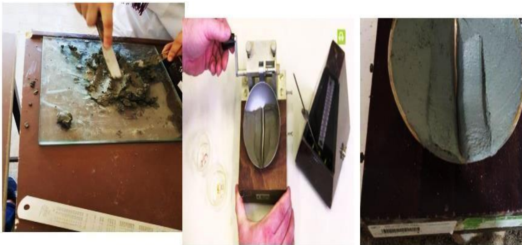
Figure III.10. Détermination de la limite de liquidité ( W_L )
