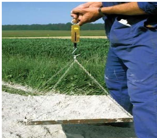
Figure II.18. Contrôle de l'épannage : pesée de l'agent de traitement épanné sur un plateau en aluminium.
