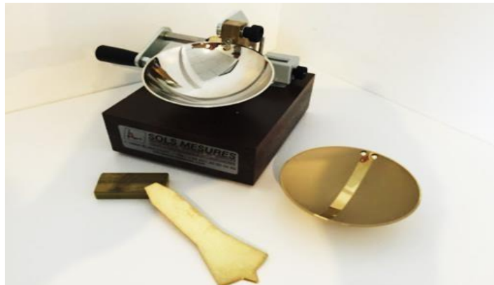
Figure III.9. Matériel de limite de liquidité.
