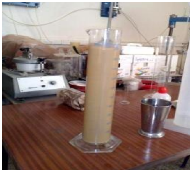
Figure III.5. Analyse granulométrique par sédimentation
