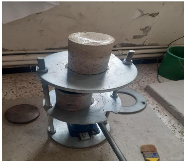
Figure IV.4. Extraction d'une éprouvette avec un cric.
