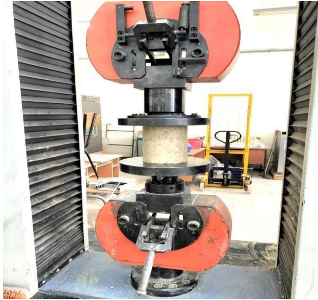
Figure V.1. Exécution de l'essai de compression uniaxiale.
