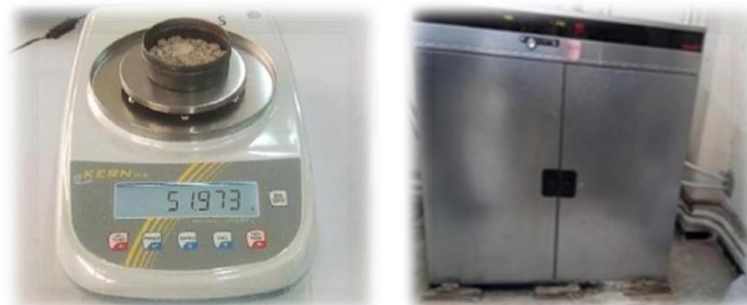
Figure III.3. Appareillage pour déterminer la teneur en eau.
