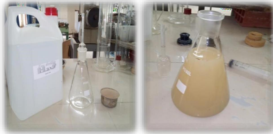
Figure III.7. Le matériel nécessaire pour la détermination de la masse volumique des particules solides du sol.
