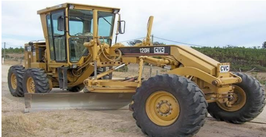
Figure II.21. Réglage d'une couche compactée avec niveleuse.
