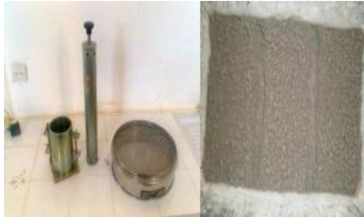
Figure IV.3. Matériel de confection des éprouvettes d'essai Proctor normal.
