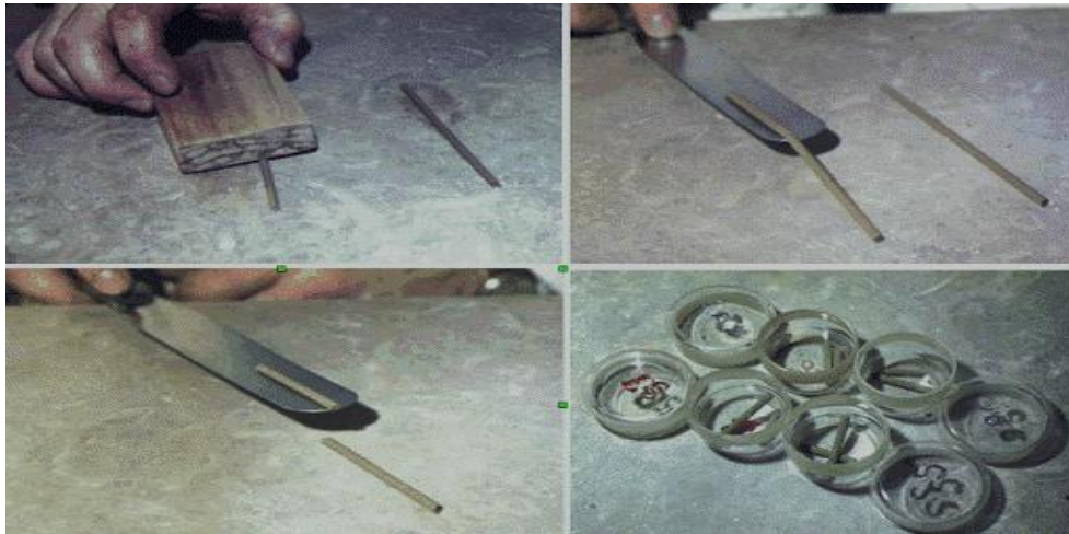
Figure III.13. Les étapes de l'essai de limite de plasticité.
