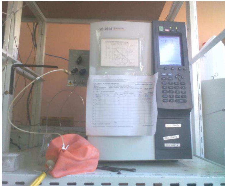
**Figure N°28** : La mesure du biogaz par la CPG (photo originale,)
