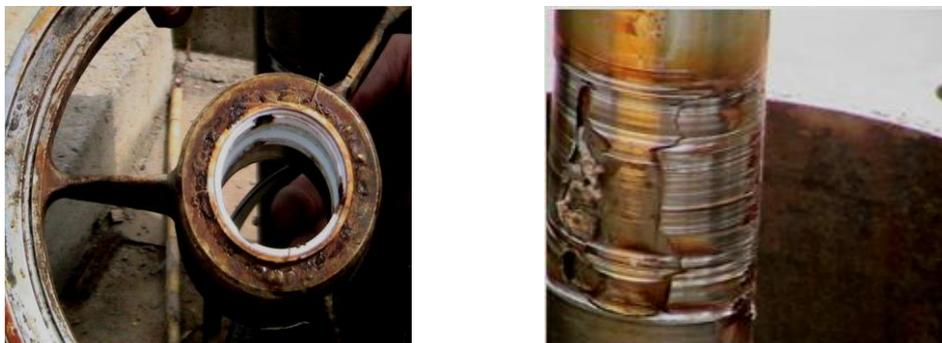
**Figure 11:** L'usure des chemises et des coussinets Après le démontage de la pompe
