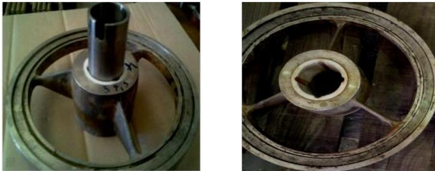
**Figure 10:** La chemise et le coussinet Avant le montage
