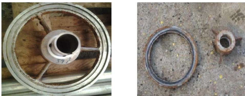
Figure 13: Rupture des Logements des paliers
