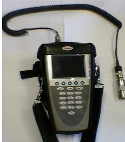
**Figure 1** : Appareil portable de mesure de vibration OneProdMVP-2C avec un accéléromètre ASH 201-A.
