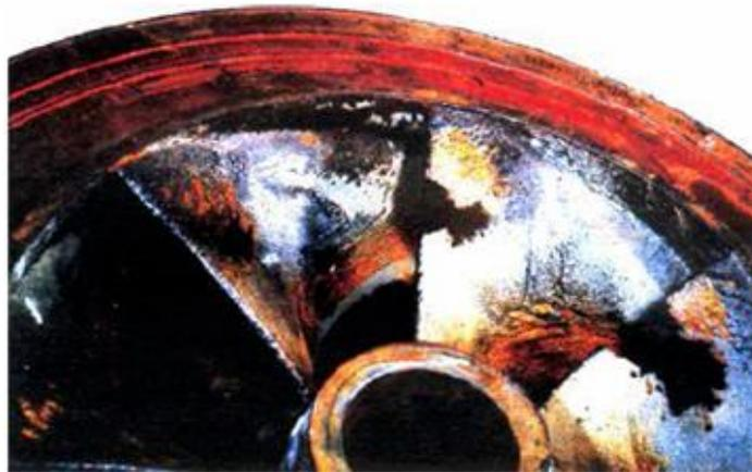
Figure II-14: Érosion par cavitation d'une roue de pompe centrifuge [6]
