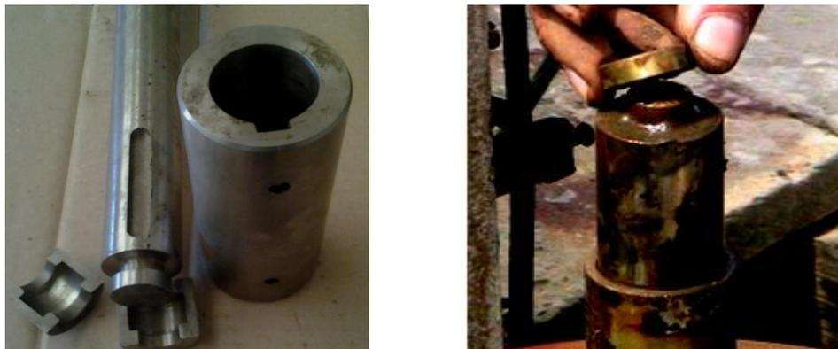
Figure 12 : Rupture des accouplements
