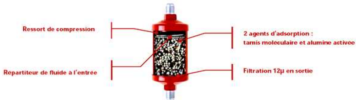
Figure II.8 Modèle d'un filtre déshydrateur 12 µ.
