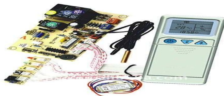
Figure III.15. Carte électronique universelle U05PG.
