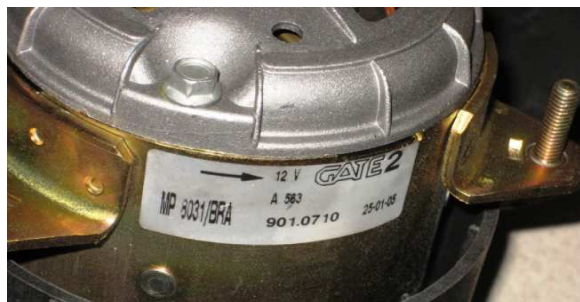
Figure III.11 Moteur asynchrone 12volt, 1450 tr/min.
