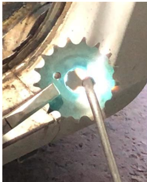
Figure IV.37: sur chauffage du pignon a l'aide d'un chalumeau.
