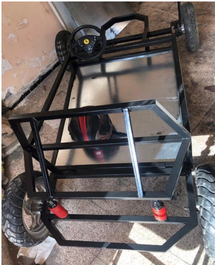
Figure IV.49: vue d'ensemble sur le résultat final de l'application de la peinture.
