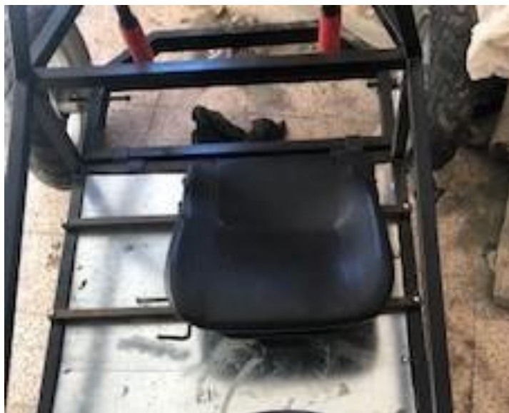
Figure IV.41 : Fixation du siège sur le châssis aux deux supports.
