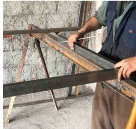
Figure IV.2 : Construction de la base du châssis.
