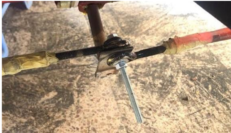
Figure IV.31 : Aperçu sur l'assemblage des deux bras de force à la colonne de direction.
