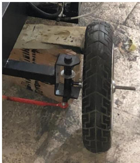
Figure IV.19 : Aperçu sur la fixation d'une des deux roues avant.
