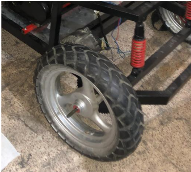
Figure IV.20 : aperçu sur la fixation d'une des deux roues arrière.
