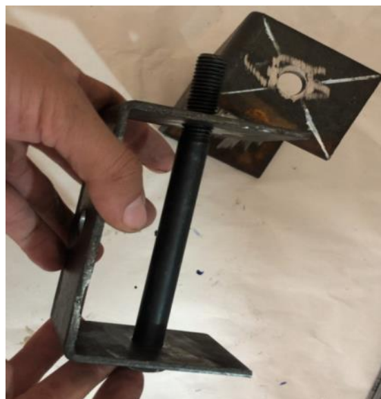
Figure IV.9 : Les fourches avant traversées par l'axe.
