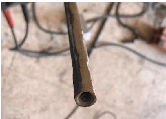
Figure IV.28: Vue sue le taraudage des bras de force.
