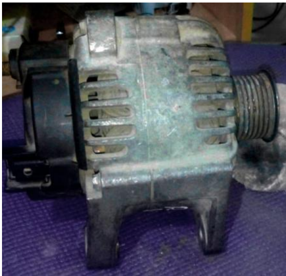
Figure IV.61 : alternateur Renault 14V 50-110a modifier de
