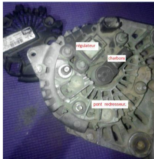
Figure IV.62 : les composant a l'alternateur
