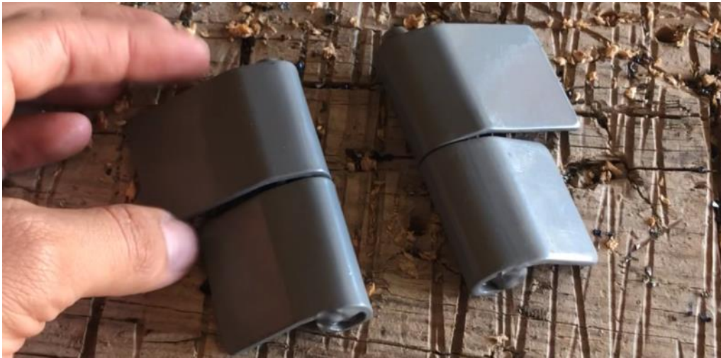
Figure IV.5 : Les pommelles permettant au châssis de se plier.
