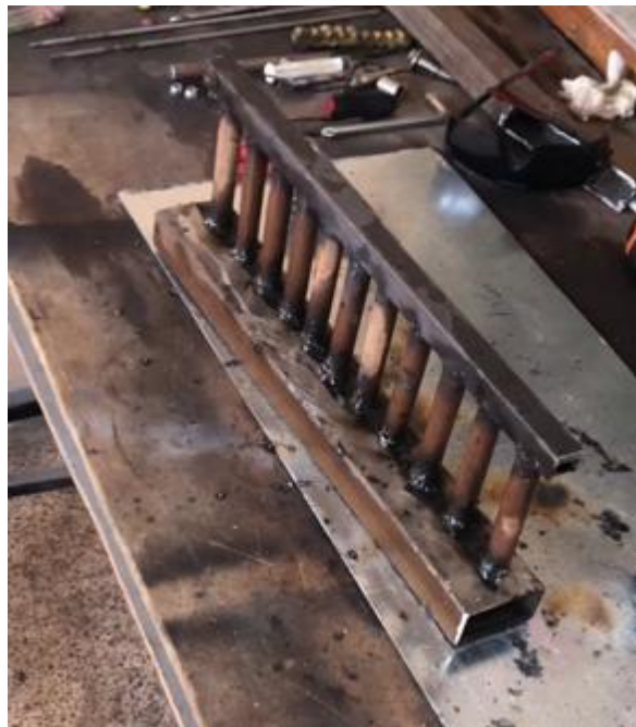
Figure IV.51 : Résultat de la calandre après soudage.
