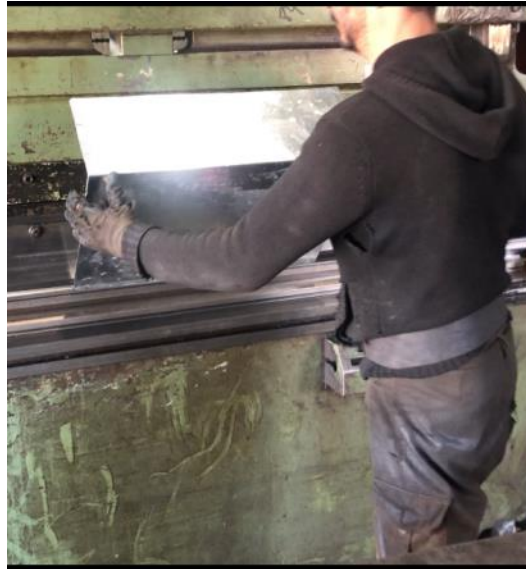
Figure IV.52 : Procédé de fabrication du capot.
