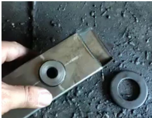
Figure IV.8 : Accordage des bagues au châssis arrière.
